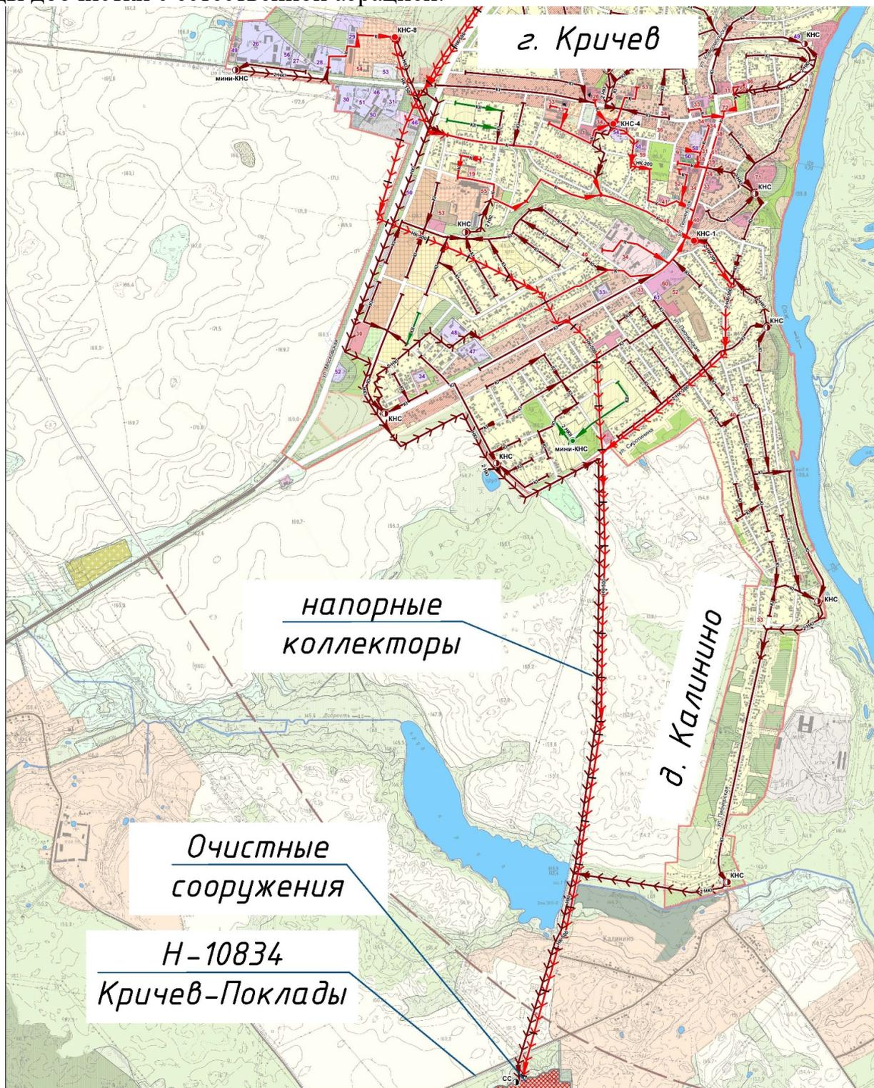
Рисунок 2.1 – Ситуационная схема расположения очистных сооружений и напорного коллектора
